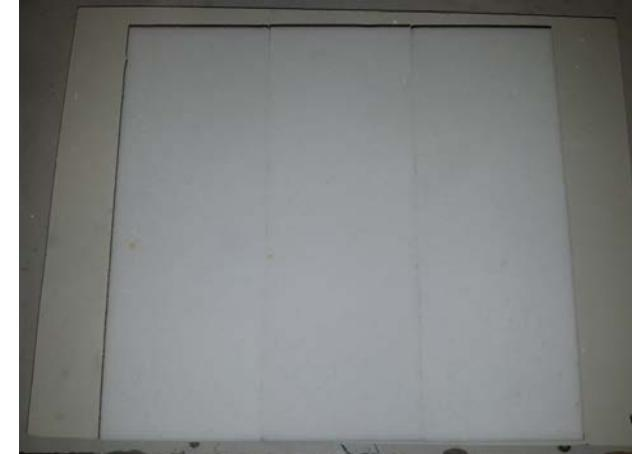
Aspecto de la muestra antes del ensayo de inflamabilidad según EN ISO 11925-2 (aplicado en borde)
